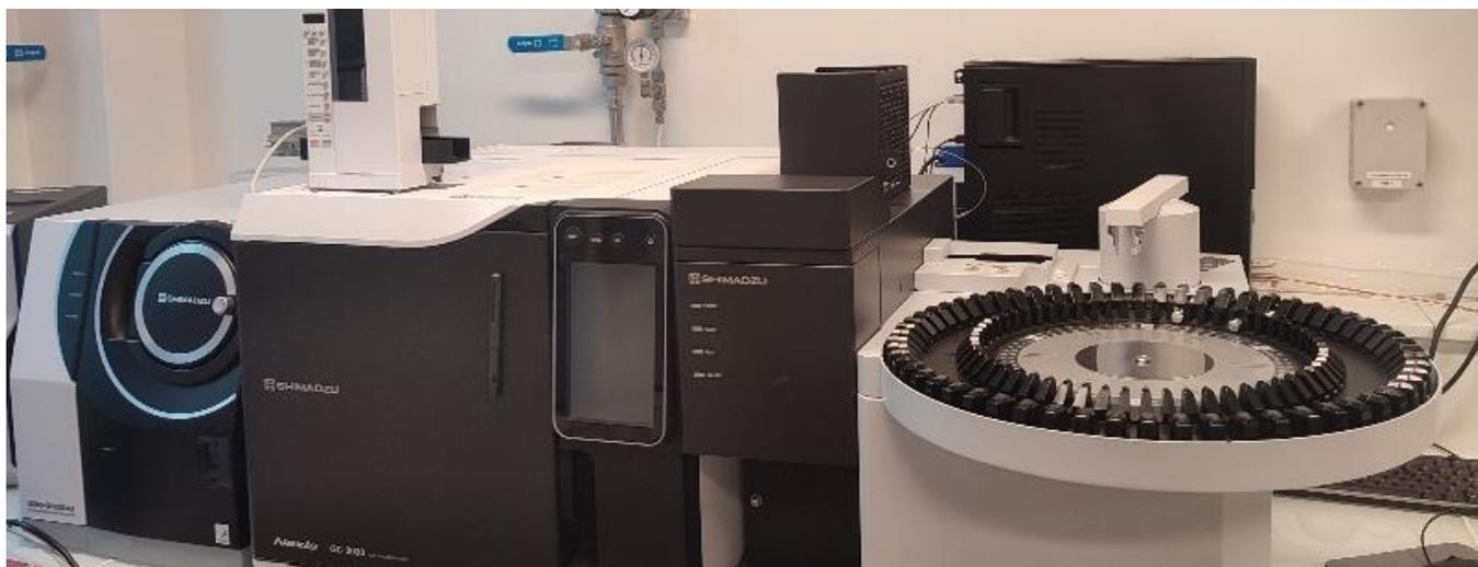
**Figure 1.** Thermodésorbeur Shimadzu TD-30R couplé à la GCMS QP2020 NX avec injecteur automatique AOC-20i+ et passeur d'échantillons.
